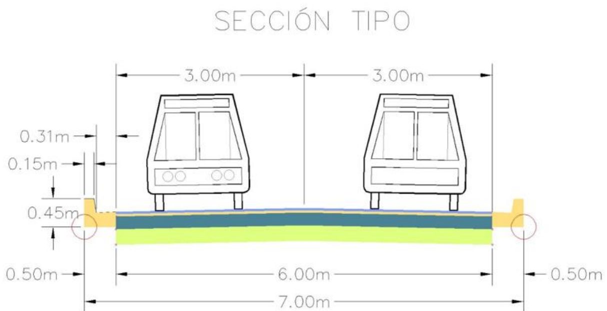
Figura 7-5: Sección tipo de la vía Fuente: KAWSUS CIA. LTDA; Elaborado por: KAWSUS CIA. LTDA
